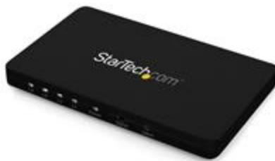
El conmutador HDMI 4K de 4 puertos, modelo VS421HD4K, permite el uso compartido de una pantalla o un proyector con cuatro dispositivos fuente equipados con audio / video HDMI. El conmutador incluye cuatro entradas independientes, cada una de las cuales es compatible con la resolución 4K y el audio de sonido envolvente 7.1.
