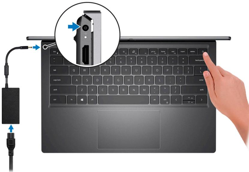
**NOTA:** Para conservar la energía de la batería, es posible que esta entre en el modo de ahorro de energía. Para encender el equipo, conecte el adaptador de alimentación y presione el botón de encendido.
