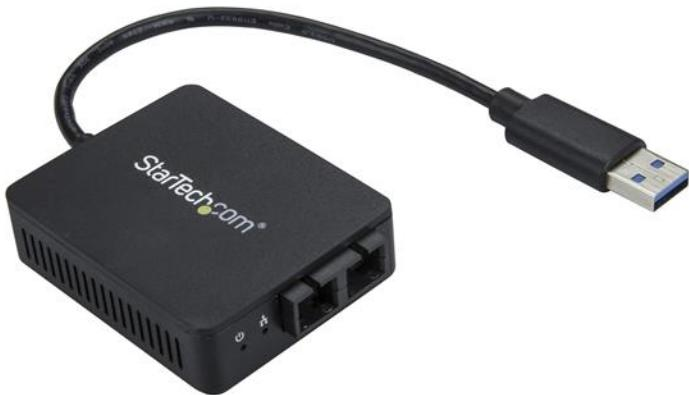
Este convertidor de USB a fibra óptica le permite utilizar el puerto USB 3.0 (Type-A) en su ordenador portátil o tablet para proporcionar una conexión de red de fibra segura. Compatible con Windows® y Mac, el adaptador de red proporciona una conexión de red Ethernet de 1000Mbps y un transceptor óptico 1000Base-SX SC.
