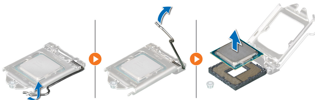
Ilustración 53. Extracción del procesador
