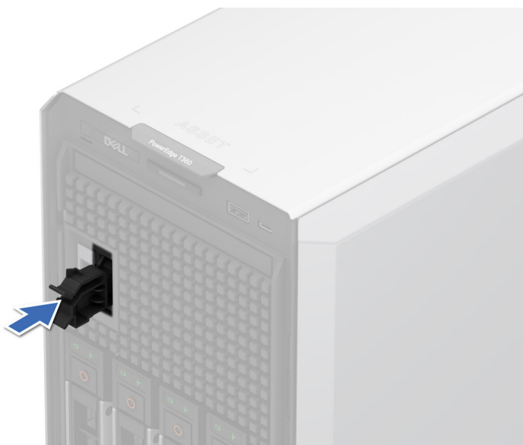
Ilustración 100. Instalación del módulo de BOSS-N1 de relleno
