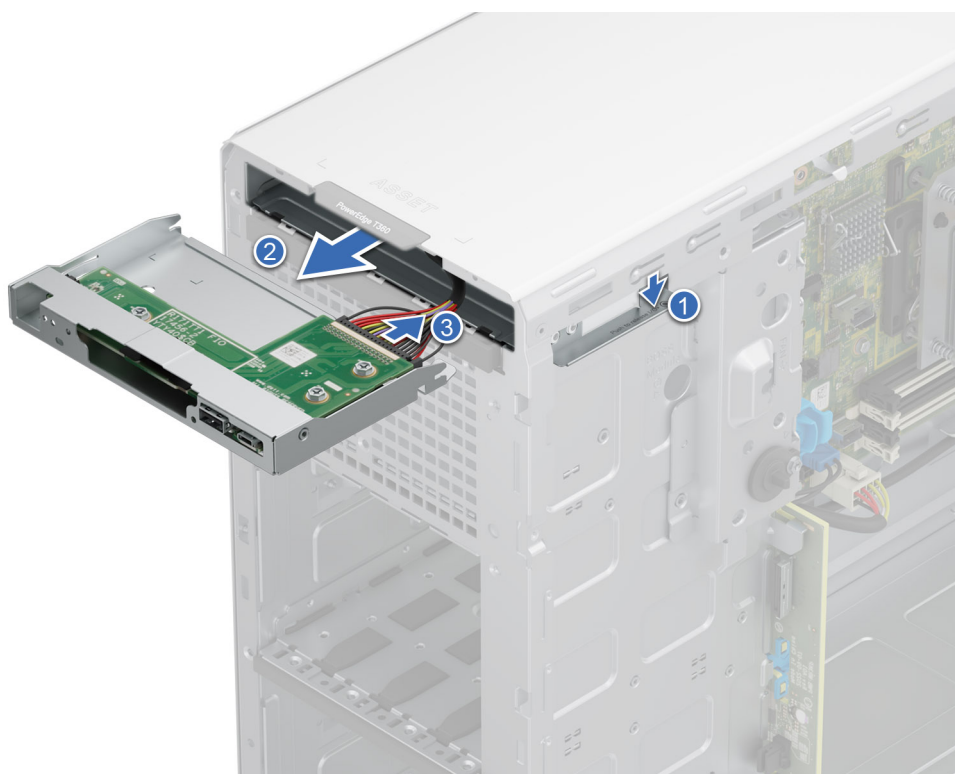
Ilustración 93. Extracción de la canastilla del panel de control
