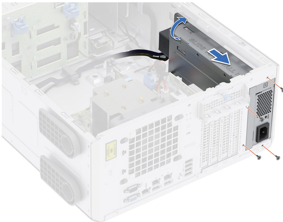
Ilustración 83. Instalación de la canastilla de la PSU
