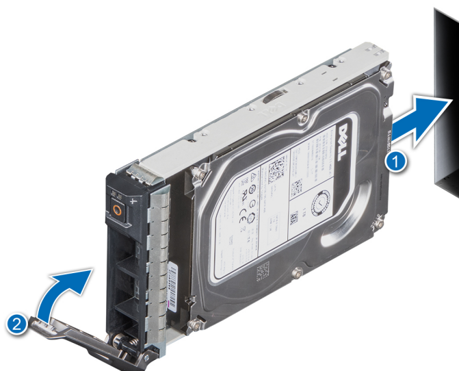
Ilustración 27. Instalación de un portaunidades
