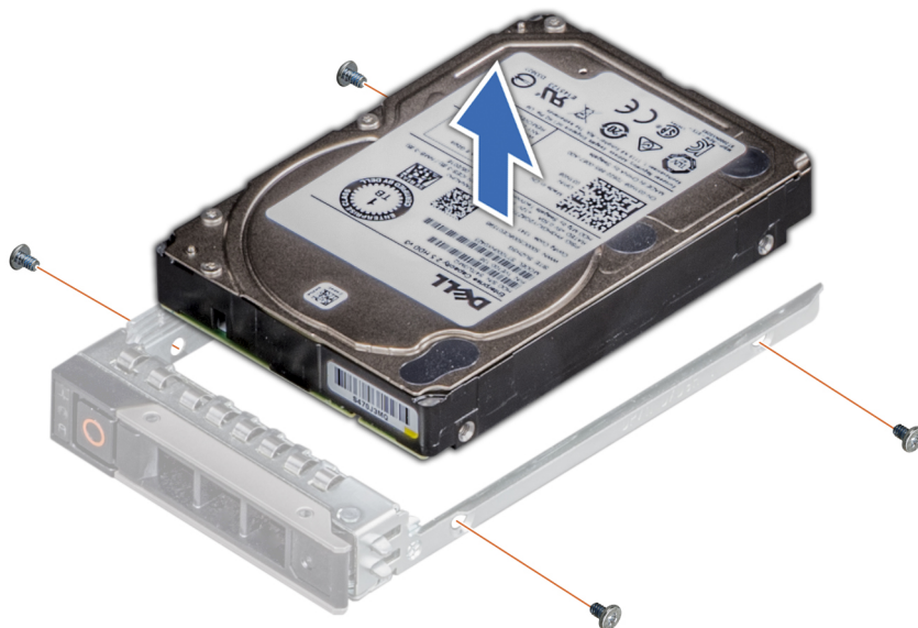
Ilustración 28. Extracción de una unidad del portaunidades
