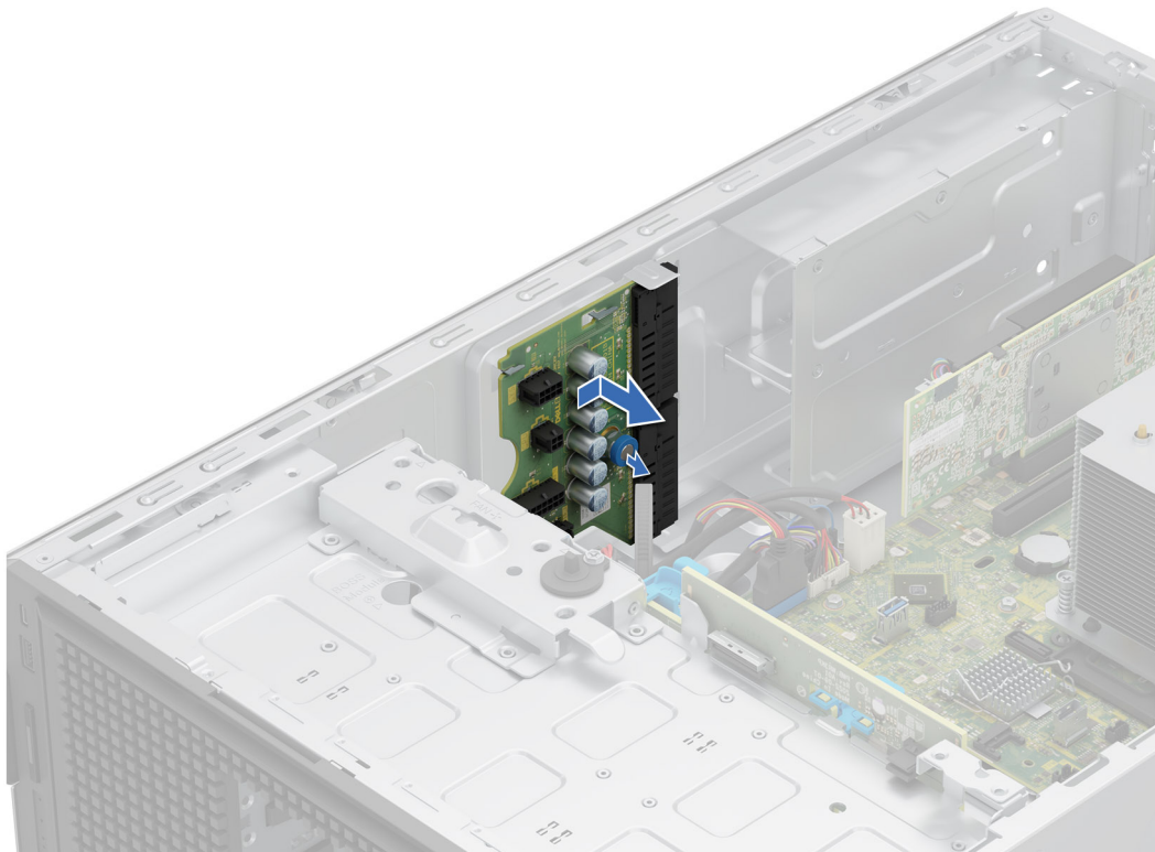
Ilustración 84. Extracción de la tarjeta mediadora de alimentación
