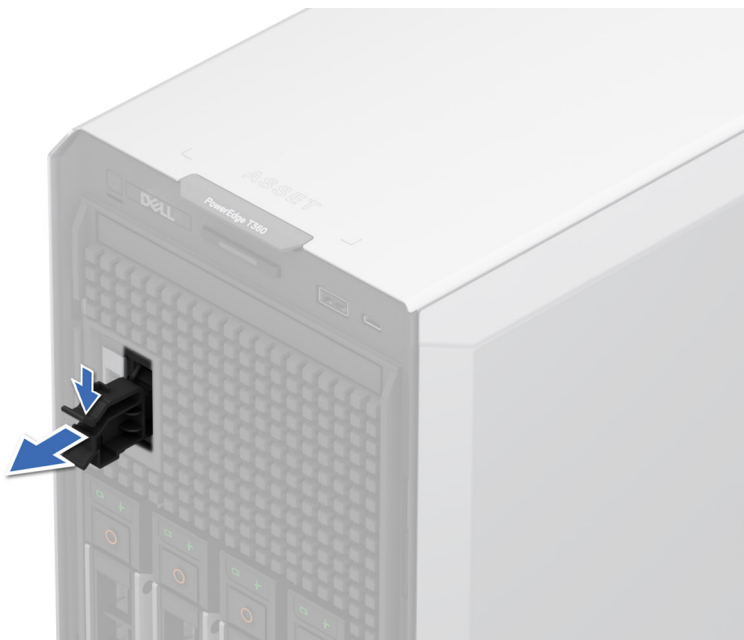
Ilustración 68. Extracción del módulo de BOSS-N1 de relleno
