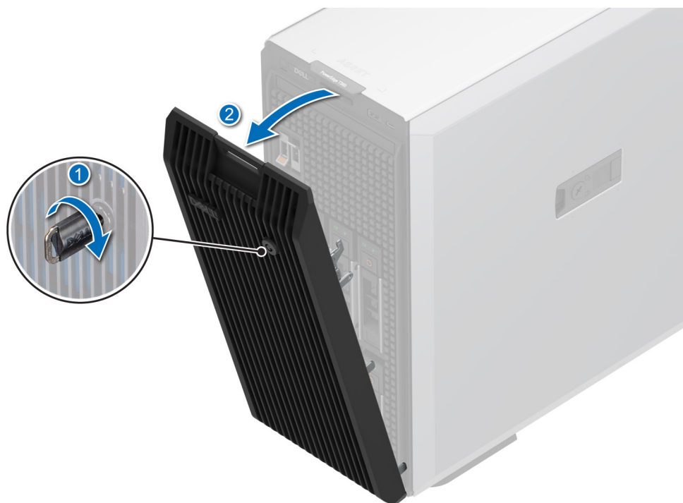
Ilustración 12. Extracción del bisel frontal
