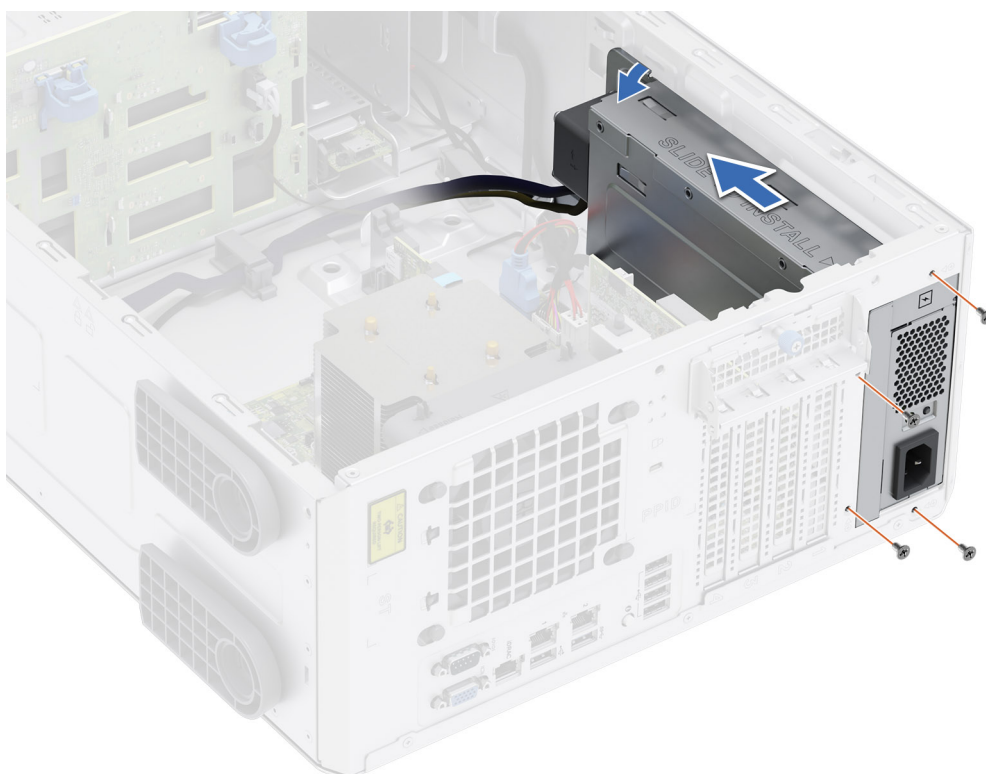
Ilustración 80. Extracción de la canastilla de la PSU
