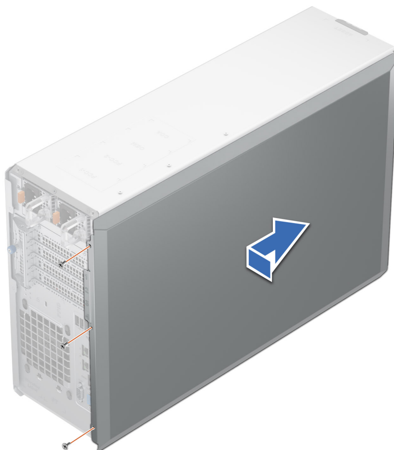
Ilustración 98. Instalación de la cubierta lateral del sistema
