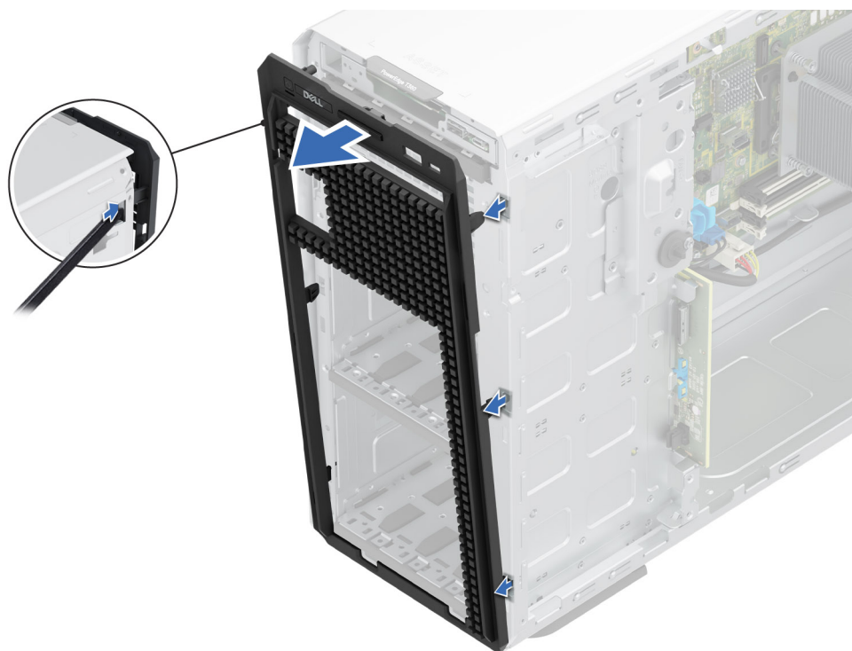
Ilustración 92. Extracción de la placa frontal
