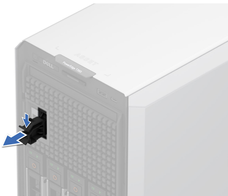
Ilustración 73. Extracción del portatarjetas de BOSS-N1 de relleno
