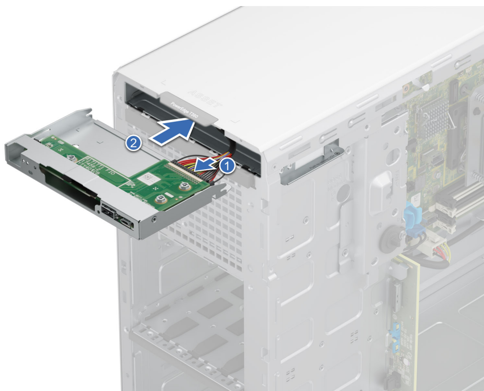
Ilustración 96. Instalación de la canastilla del panel de control
