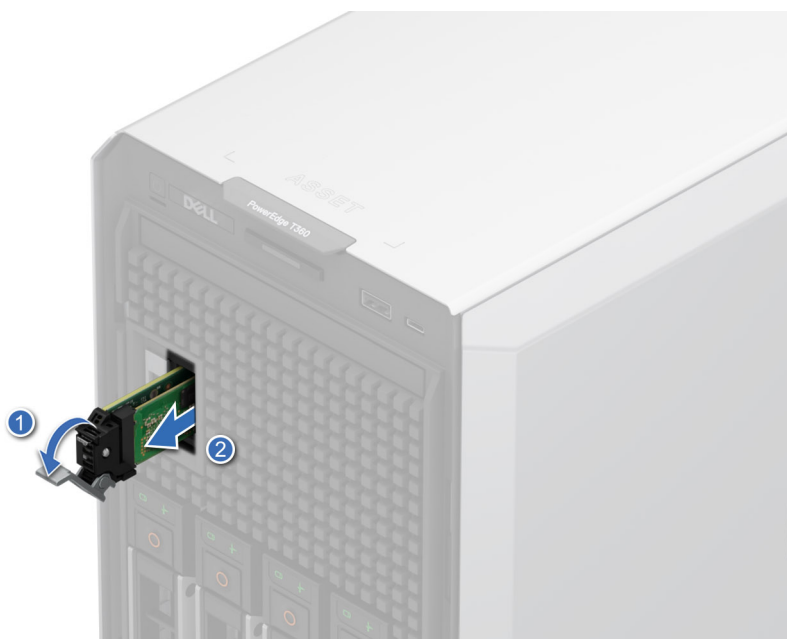
Ilustración 70. Extracción del portaunidades de tarjeta BOSS-N1
