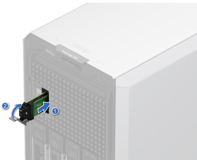
Ilustración 75. Instalación del portatarjetas de BOSS-N1
