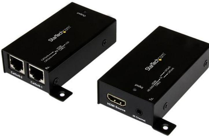
El kit extensor de video HDMI® a través de CAT5e/CAT6, modelo ST121SHD30, permite extender una señal HDMI de audio/video, así como una señal infrarroja de mando a distancia hasta 30 metros, a través de dos cables CAT5. Otra característica que añade versatilidad a este kit extensor HDMI es que obtiene la alimentación a través del bus HDMI y no requiere ningún adaptador de alimentación adicional.
