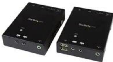
Este kit extensor HDMI utiliza tecnología HDBaseT 2.0, lo cual le permite extender el alcance de vídeo 4K HDMI y cuatro dispositivos periféricos USB 2.0 a una ubicación remota situada a hasta 90 metros de distancia mediante el uso de un solo cable CAT5e o CAT6. El extensor puede ampliar el vídeo 1080p (HD) aún más, a hasta 100 metros.
