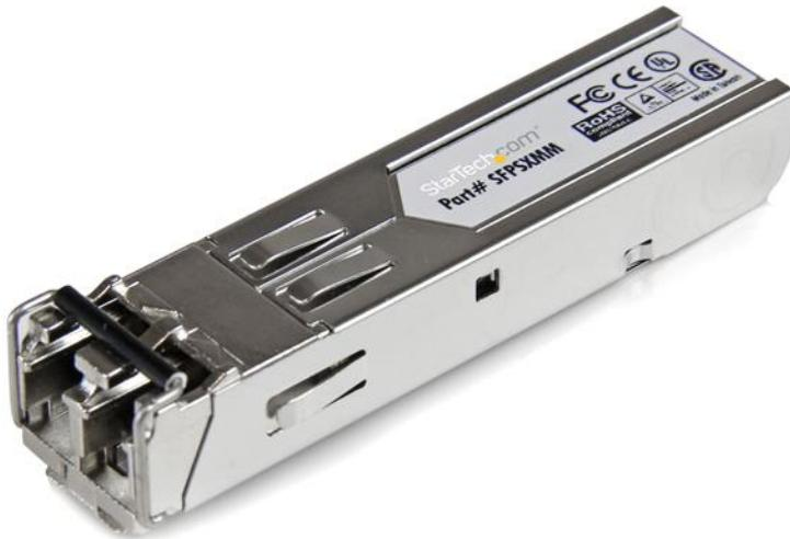
El modelo SFPSXMM es un transceptor SFP por fibra óptica, conforme a las normas MSA y TAA, diseñado, programado y probado para su funcionamiento con enrutadores y commutadores 1000BASE-SX compatibles con MSA. El módulo transceptor SFP admite una distancia máxima de hasta 550m y conectividad fiable a 10GbE a través de cableado de fibra.
