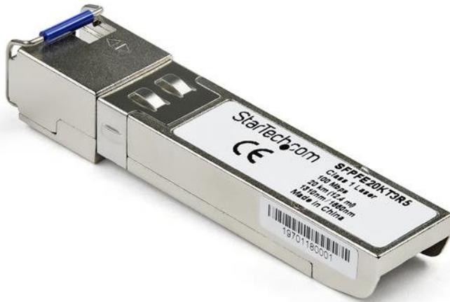
El modelo SFPFE20KT3R5 es un transceptor SFP upstream por fibra óptica compatible con el modelo SFP-FE20KT13R15 de Juniper, que se puede emparejar con SFPFE20KT5R3 de StarTech.com. Ha sido diseñado, programado y probado para su funcionamiento con routers y switches MSA compatibles con 100Base-BX10-U. El módulo transceptor SFP+ admite una distancia máxima de hasta 20 km y conectividad confiable a 100 MbE a través de cableado de fibra óptica.
