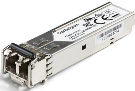
El modelo SFP1GSXEMCST es un módulo transceptor SFP por fibra óptica compatible con el modelo SFP-1G-SX de Dell EMC diseñado, programado y probado para su funcionamiento con routers y switches de la marca Dell EMC™. Ofrece conectividad confiable a 1 GbE, a través de cable de fibra óptica, para redes compatibles con 1000Base-SX, a una distancia máxima de hasta 550 m.
