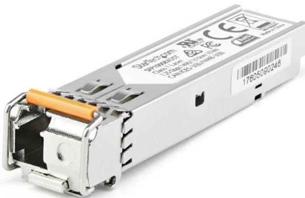
El modelo SFP1GBX40DES es un transceptor SFP downstream por fibra óptica compatible con el modelo SFP-1G-BX40-D de Dell EMC, que se puede emparejar con SFP1GBX40UES de StarTech.com. Ha sido diseñado, programado y probado para su funcionamiento con routers y switches MSA compatibles con 1000Base-BX40. El módulo transceptor SFP+ admite una distancia máxima de hasta 40 km y conectividad confiable a 1 GbE a través de cableado de fibra óptica.
