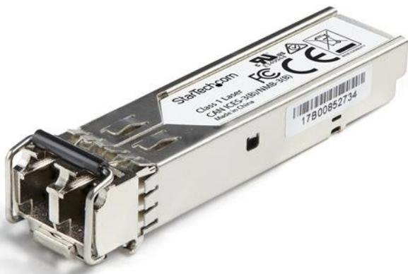
El modelo SFP1FEFXST es un módulo transceptor SFP por fibra óptica compatible con el modelo SFP-1FE-FX de Juniper diseñado, programado y probado para su funcionamiento con routers y switches de la marca Juniper®. Ofrece conectividad confiable a 100 MbE, a través de cable de fibra óptica, para redes compatibles con 100Base-FX, a una distancia máxima de hasta 2 km.
