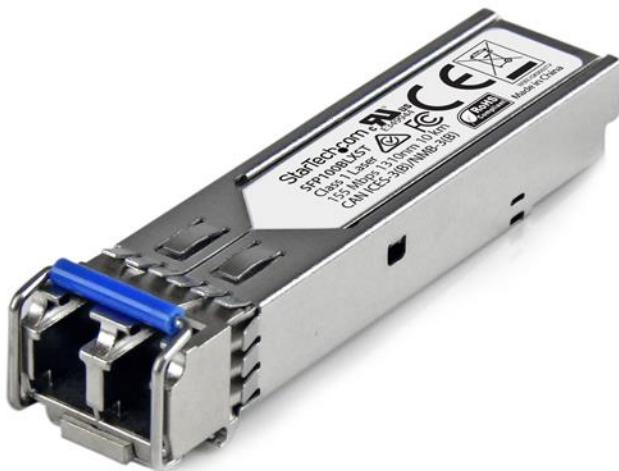
El modelo SFP100BLXST es un transceptor SFP por fibra óptica, conforme a las normas MSA, diseñado, programado y probado para su funcionamiento con enrutadores y conmutadores 100BASE-LX compatibles con MSA. El módulo transceptor SFP admite una distancia máxima de hasta 10km y conectividad fiable Ethernet a 100Mb a través de cableado de fibra.
