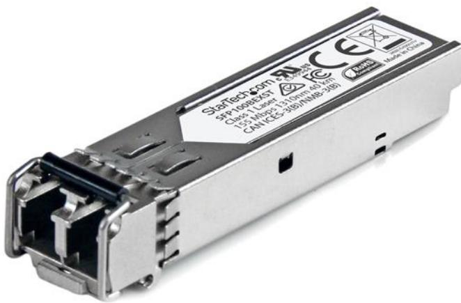
El modelo SFP100BEXST es un transceptor SFP por fibra óptica, conforme a las normas MSA, diseñado, programado y probado para su funcionamiento con enrutadores y commutadores 100BASE-EX compatibles con MSA. El módulo transceptor SFP admite una distancia máxima de hasta 40km y conectividad fiable Ethernet a 100Mb a través de cableado de fibra.
