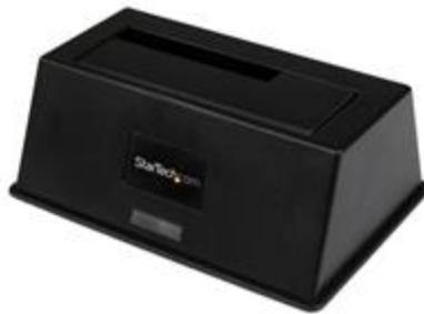
La versátil estación de conexión USB 3.0 / eSATA con UASP, modelo SDOCKU33EBV, permite conectar e intercambiar unidades SATA III de disco duro (HDD) y de estado sólido (SSD) de 2,5" o 3,5", con la opción de conexión a través de USB o eSATA.
