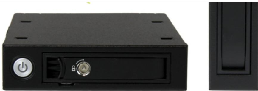
El backplane se puede instalar vertical u horizontalmente, para facilitar la inserción en bandeja sin errores y máxima compatibilidad con servidores u ordenadores de sobremesa. Es posible bloquear la bandeja de acero extraíble, para mayor nivel de protección de la unidad. El conector NSS ("Non-Scratch SATA", SATA sin rayaduras/fricción en el disco) ofrece una prolongada durabilidad de más de 50.000 inserciones, lo cual garantiza un rendimiento duradero tanto de las unidades, como de la bahía.
