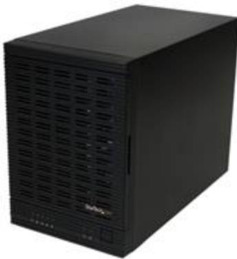
La caja extraíble para discos duros, con 5 bahías, modelo S355BU33ERM, permite el acceso simultáneo a cinco unidades individuales de disco duro de 2,5" o 3,5", mediante una sola conexión de un puerto eSATA o USB con un ordenador portátil o de sobremesa.
