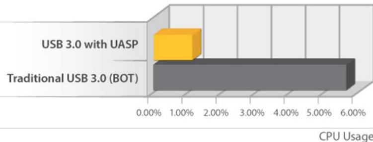
Los resultados de las pruebas se obtuvieron al utilizar un sistema Ivy Bridge de Intel®, una caja de StarTech.com con UASP disponible, así como una unidad SATA III de estado sólido (SSD).
