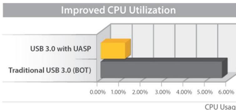
Los resultados de las pruebas se obtuvieron al utilizar un sistema Ivy Bridge de Intel®, una caja de StarTech.com con UASP disponible, así como una unidad SATA III de estado sólido (SSD).
