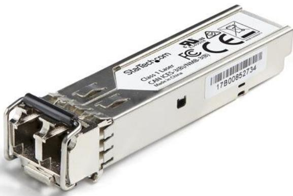
El modelo RX70KMSFPST es un módulo transceptor SFP por fibra óptica compatible con el modelo RX-70KM-SFP de Juniper diseñado, programado y probado para su funcionamiento con routers y switches de la marca Juniper®. Ofrece conectividad confiable a 1 GbE, a través de cable de fibra óptica, para redes compatibles con 1000Base-ZX, a una distancia máxima de hasta 70 km.
