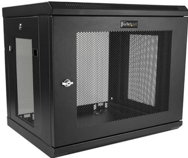
Este armario 9U para racks de servidores le permite instalar sus equipos compatibles con la norma EIA-310 en una pared. La caja tiene una profundidad de montaje de 15,2cm a 43,1cm y capacidad máxima de carga de 90kg.
