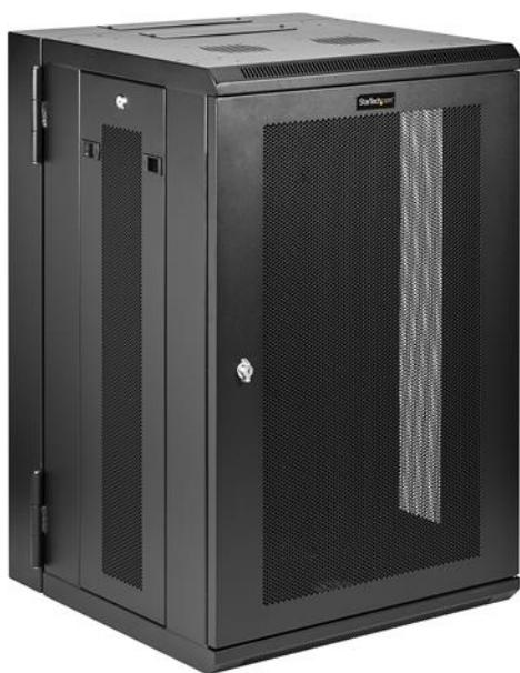
Este armario 18U para racks de servidores o redes le permite instalar equipos compatibles con la norma EIA-310 en una pared, en una caja segura con puerta trasera abisagrada, para facilitar el acceso a su equipo. La caja permite una profundidad ajustable de montaje, entre 6,1cm a 50,8cm, lo cual constituye una solución resistente de almacenamiento para su equipo de montaje en rack.
