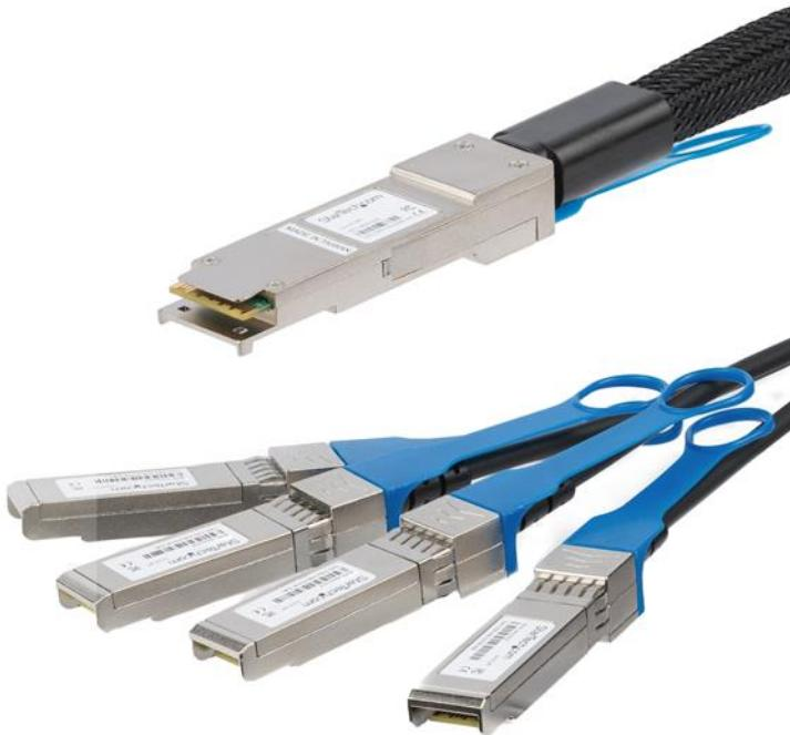
El modelo QSFP4SFPPC3M es un cable multiconector QSFP+ Twinax, con conexión directa, compatible con MSA. Está diseñado, programado y probado para su funcionamiento como puente con equipos de red a 40G con enrutadores y comutadores compatibles con 10G. Este cable Twinax (Twin axial) pasivo conecta un solo puerto QSFP+ a cuatro puertos SFP+ 10G, y permite el intercambio en caliente, lo cual facilita las actualizaciones y reemplazos, ya que minimiza las interrupciones de conexión en red.
