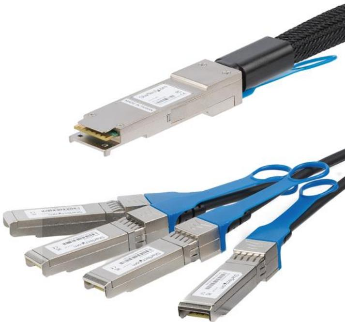
El modelo QSFP4SFPPC3M es un cable multiconector QSFP+ Twinax, con conexión directa, compatible con MSA. Está diseñado, programado y probado para su funcionamiento como puente con equipos de red a 40G con routers y comutadores compatibles con 10G. Este cable Twinax (Twin axial) pasivo conecta un solo puerto QSFP+ a cuatro puertos SFP+ 10G, y permite el intercambio en caliente, lo cual facilita las actualizaciones y reemplazos, ya que minimiza las interrupciones de conexión en red.
