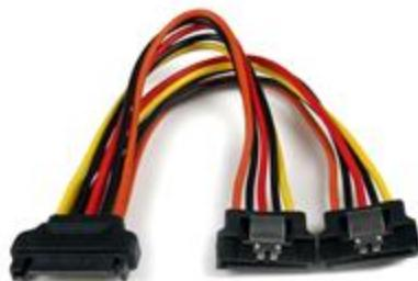
El cable divisor de alimentación SATA (15 cm), modelo PYO2LSATA, incluye un conector SATA de 15 pinos que se enchufa a un único conector SATA de alimentación de un ordenador y se divide en dos receptáculos SATA de 15 pinos con cierre, lo cual permite conectar dos discos duros Serial ATA a una sola toma de conexión de alimentación SATA del sistema de alimentación del ordenador.
