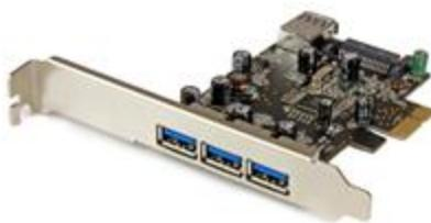
He aquí una solución económica para agregar conectividad USB 3.0 a su ordenador. Esta tarjeta PCIe USB 3.0 de 4 puertos ofrece tres puertos externos y un puerto interno, a fin de proporcionar lo último en flexibilidad de conectividad.
