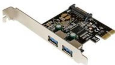
La tarjeta PCI Express USB 3.0 de 2 puertos, modelo PEXUSB3S23, permite agregar dos puertos USB 3.0 a un sistema de PC equipado con PCI Express. La tarjeta USB requiere alimentación SATA para tener funcionalidad, y ofrece 900 mA de alimentación por puerto a dispositivos USB 3.0 conectados (500 mA para USB 2.0), haciendo uso del conector SATA de la fuente de alimentación de su ordenador.
