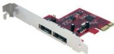
La Tarjeta Controladora PCI Express eSATA de 2 Puertos (6 Gbps), PEXESAT32 ofrece conectividad simple entre un ordenador host y dispositivos eSATA 3.0 – una solución eficaz y económica para conectar almacenamiento de alta velocidad, como por ejemplo Discos Duros de Alta Capacidad y Unidades de Estado Sólido (SSD), lo que a su vez facilita la realización de copias de seguridad y archivos.
