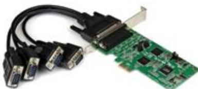
La tarjeta de combinación serial PCI Express PCIe de 4 puertos (2 x RS232, 2 x RS422 / RS485), PEX4S232485, permite agregar al ordenador cuatro puertos seriales, dos RS232 y dos RS422/485, mediante una ranura de expansión PCI-Express.
