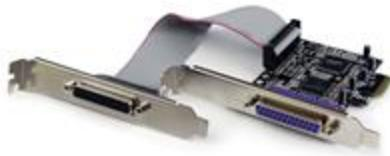
La Tarjeta Adaptadora PCI Express Paralelo de 2 Puertos - tarjeta paralelo EPP/ECP/SPP/PS2, PEX2PECP2 permite agregar dos puertos paralelos IEEE 1284 a una PC y ofrece soporte para comunicación de datos a través de puertos paralelos a velocidades de hasta 1,5 Mbps.
