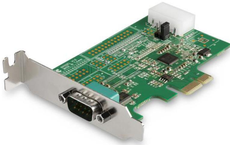
Esta tarjeta adaptadora serie RS232 le permite agregar a su ordenador un puerto serie RS232 DB9, a través de una ranura PCI Express (PCIe). Le permite interactuar con dispositivos serie, como lectores de tarjetas, impresoras, terminales PIN Pad o módems, a velocidades de hasta 921,4Kbps.
