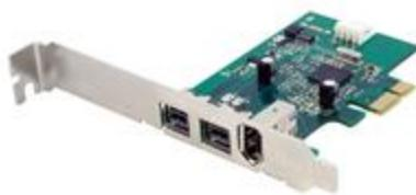
Esta tarjeta adaptadora PCI Express de 3 puertos Fire Wire se puede instalar en una ranura PCI Express para añadir dos puertos IEEE1394b (FireWire 800 – 9 pines) y un puerto IEEE1394a (FireWire 400 – 6 pines), brindando compatibilidad con un amplio rango de dispositivos FireWire (p. ej. cámaras grabadoras de vídeo digital, discos duros externos, cámaras digitales, etc.).
