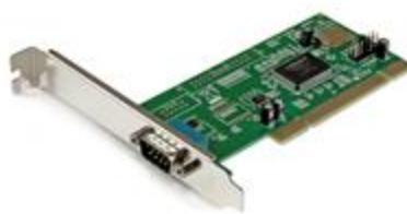
La tarjeta serial PCI 16550, modelo PCI1S550, se puede instalar en una ranura PCI, a fin de agregar un puerto serial RS232: solución económica para la conexión de cualquier dispositivo serial actual o de generación anterior, con tasas de transferencia de datos de hasta 115,2 Kbps.
