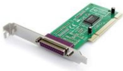
La tarjeta adaptadora de puerto paralelo EPP/ECP de alto rendimiento basada en PCI se puede instalar en una ranura PCI de un ordenador para añadir un puerto paralelo IEEE 1284. Es una manera eficaz y económica de conectar dispositivos paralelos al ordenador alcanzando velocidades de transferencia de datos de hasta 1,5 Mbps (hasta 3 veces más rápido que con puertos paralelos integrados).
