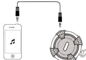
**Importante:** Si estás utilizando la bocina en su modo de conexión auxiliar 3.5 mm la protección IP disminuye ya que los conectores no están protegidos por la cubierta, para usar la bocina en ambientes húmedos la cubierta debe estar correctamente cerrada.
