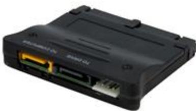
El PATA2SATA3 es un adaptador/conversor bidireccional SATA/IDE que permite conectar una unidad Serial ATA a un puerto IDE preexistente, o una unidad IDE a un puerto SATA de la placa madre.
