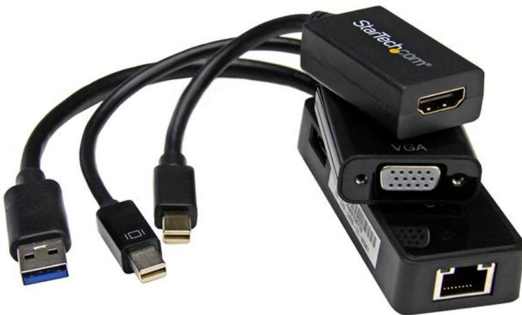
Este kit de adaptadores para Surface Pro le permite aprovechar al máximo su equipo Microsoft® Surface™ Pro o Surface Book (retrocompatible con Surface Pro 4, Surface Pro 3, Surface 3 y Surface Pro 2), al integrarle compatibilidad con vídeo HDMI® y VGA, así como conectividad de red por cable.
