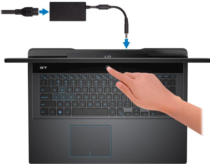
**NOTA:** Para conservar la energía de la batería, es posible que esta ingrese en modo de ahorro de energía. Para encender el equipo, conecte el adaptador de alimentación y presione el botón de encendido.
