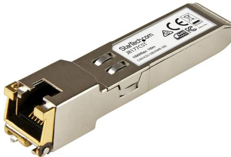
El modelo J8177CST es un módulo transceptor por cobre, compatible con el modelo J8177C de HP, diseñado, programado y probado para su funcionamiento con enrutadores y conmutadores de la marca HP®. Ofrece conectividad fiable a 1GbE a través de cableado de cobre, para redes compatibles con 1000BASE-T, a una distancia máxima de hasta 100m.
