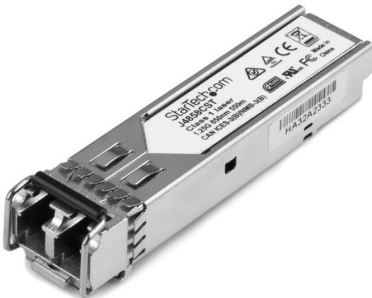
El modelo J4858CST es un módulo transceptor por fibra óptica, compatible con el modelo J4858C de HP, diseñado, programado y probado para su funcionamiento con enrutadores y conmutadores de la marca HP®. Ofrece conectividad fiable a 1GbE a través de cableado de fibra, para redes compatibles con 1000BASE-SX, a una distancia máxima de hasta 550m.
