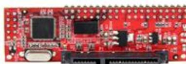
El adaptador IDE a SATA de 40 pines, modelo IDE2SAT2, permite la conexión de una unidad SATA I/II/III a un puerto IDE/ATA 33/66/100/133 de una placa base disponible, lo cual constituye una solución económica y eficaz para agregar unidades SATA más modernas a su placa base y poder seguir utilizándola.
