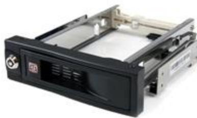
Esta bahía de intercambio en caliente para unidades de disco duro SATA de 3,5" permite instalar una unidad SATA de 3,5" en una bahía de unidad de 5,25" disponible/no utilizada. Para extraer la unidad, basta con abrir la puerta del panel frontal. Asimismo, para reinsertar una unidad, basta con insertarla (primero el conector) hasta que la puerta se cierre.
