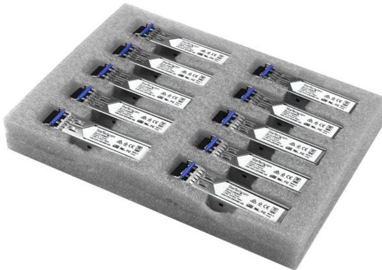
El modelo GLCLHSM10PST es un módulo transceptor por fibra óptica compatible con el modelo GLC-LH-SM de Cisco, diseñado, programado y probado para su funcionamiento con enrutadores y commutadores de la marca Cisco®. Ofrece conectividad fiable a 1GbE a través de cableado de fibra, para redes compatibles con 1000BASE-LX/LH, a una distancia máxima de hasta 10km.
