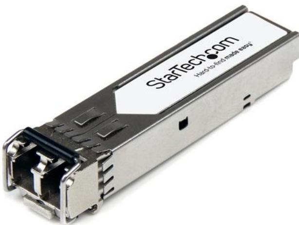
El modelo EW3P0000557-STSTST es un módulo transceptor SFP+ por fibra óptica compatible con el modelo EW3P0000557 de Citrix diseñado, programado y probado para su funcionamiento con routers y switches de la marca Citrix®. Ofrece conectividad confiable a 10 GbE, a través de cable de fibra óptica, para redes compatibles con 10GBase-SR, a una distancia máxima de hasta 300 m.
