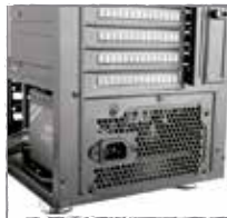
Alinear los tornillos a la fuente de poder en el lado correcto.
