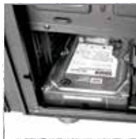
Coloca SSD ó HDD y ajusta en la posición correcta.
