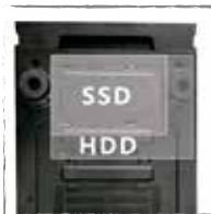
Ajusta con los tornillos. Para SSD usa tornillos M/B. Para HDD usa tornillos HDD.
