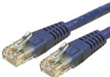
El cable para red Cat 6 de 1,8 metro, modelo C6PATCH6BL, cumple o sobrepasa las especificaciones para este tipo de cables de categoría 6, lo cual garantiza conexiones fiables en redes Gigabit, además de estar fabricado con un duradero recubrimiento de PVC de color azul que permite codificar mediante el color los cables de una red, según sea necesario.
