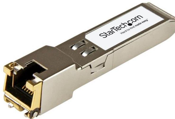
El modelo BRSFP-1GECOPR-ST es un módulo transceptor SFP por Cobre compatible con el modelo BRSFP-1GECOPR de a Brocade diseñado, programado y probado para su funcionamiento con routers y switches de la marca Brocade®. Ofrece conectividad confiable a 1 GbE, a través de cable de Cobre, para redes compatibles con 10/100/1000Base-TX, a una distancia máxima de hasta 100 m.
