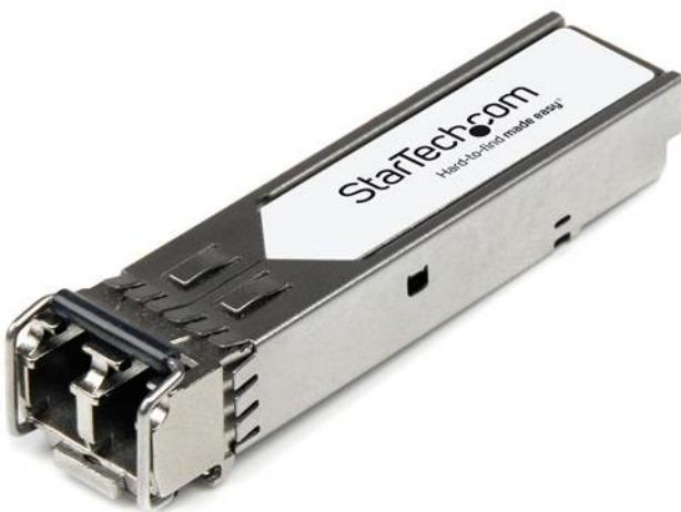
El modelo AR-SFP-1G-LX-ST-ST-ST es un módulo transceptor SFP por fibra óptica compatible con el modelo SFP-1G-LX de Arista Networks diseñado, programado y probado para su funcionamiento con routers y switches de la marca Arista Networks®. Ofrece conectividad confiable a 1 GbE, a través de cable de fibra óptica, para redes compatibles con 1000Base-LX, a una distancia máxima de hasta 10 km.
