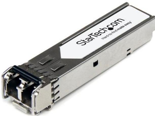
El modelo 57-0000075-01-ST1-ST1-ST es un módulo transceptor SFP+ por fibra óptica compatible con el modelo 57-0000075-01-ST1-ST1 de Brocade diseñado, programado y probado para su funcionamiento con routers y switches de la marca Brocade®. Ofrece conectividad confiable a 10 GbE, a través de cable de fibra óptica, para redes compatibles con 10GBase-SR, a una distancia máxima de hasta 300 m.
