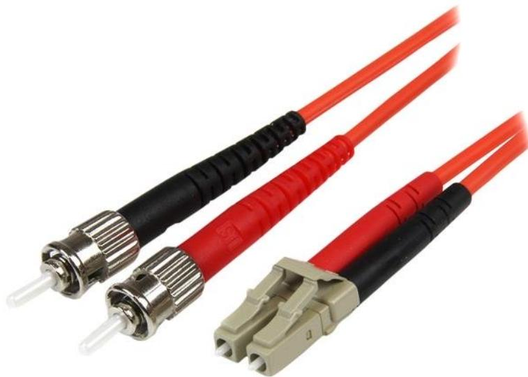
El cable de fibra óptica (2 m), categoría LSZH, LC a ST, modelo 50FIBLCST2, con fibra óptica de 50/125 micrones para alta velocidad, proporciona transmisiones de datos a alto ancho de banda a través de redes Gigabit Ethernet y canal de fibra, con soporte para aplicaciones dúplex multimodo.
