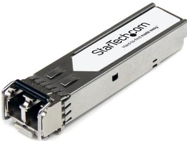
El modelo 10G-SFPP-SR-STSTST es un módulo transceptor SFP+ por fibra óptica compatible con el modelo 10G-SFPP-SR de Brocade diseñado, programado y probado para su funcionamiento con routers y switches de la marca Brocade®. Ofrece conectividad confiable a 10 GbE, a través de cable de fibra óptica, para redes compatibles con 10GBase-SR, a una distancia máxima de hasta 200 m.
